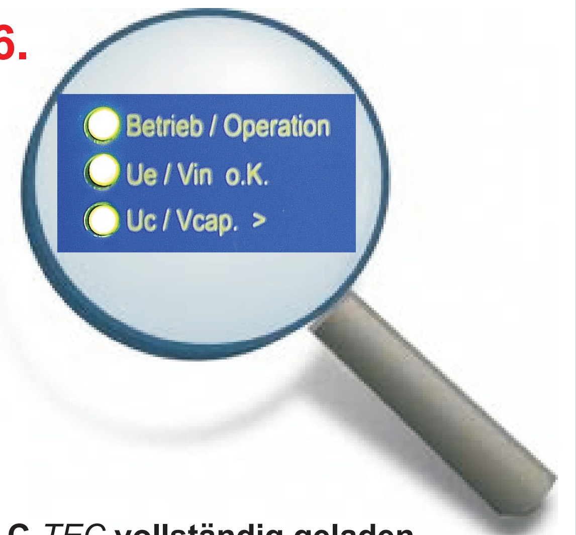
AC C-TEC vollständig geladen. Die LEDs „Betrieb/Operation“, „U e /V in o.K.“ und „U c /V cap >“ leuchten
