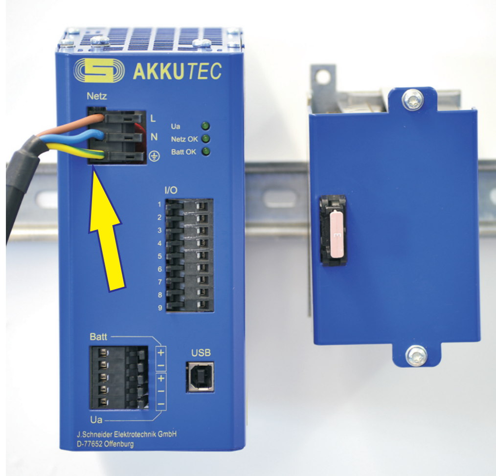
Anschluss des AKKUTEK an das Versorgungsnetz (230VAC)
