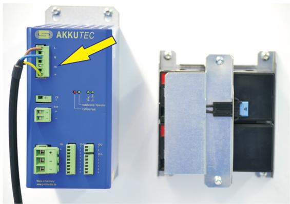
Anschluss des AKKUTECH an das Versorgungsnetz (230VAC)
