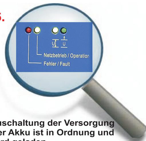
Zuschaltung der Versorgung. Der Akku ist in Ordnung und wird geladen. Die LEDs „Netzbetrieb/Operation“ und „Batteriespannung ok“ leuchten.
