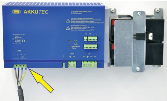
Anschluss des AKKUTECH an das Versorgungsnetz (400VAC)
