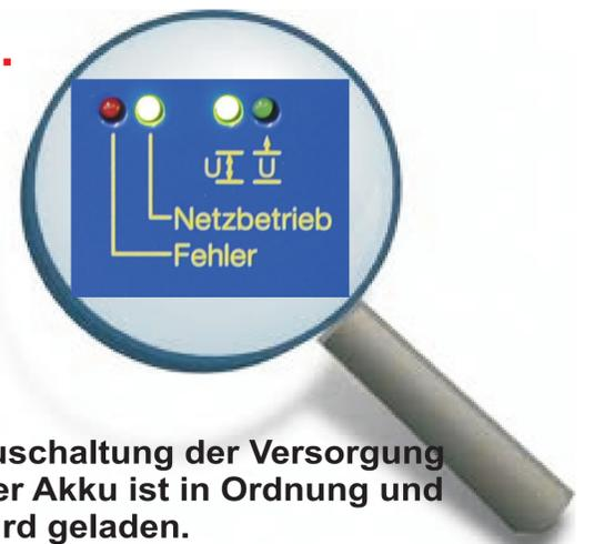
Zuschaltung der Versorgung. Der Akku ist in Ordnung und wird geladen. Die LEDs „Netzbetrieb“ und „Batteriespannung ok“ leuchten.
